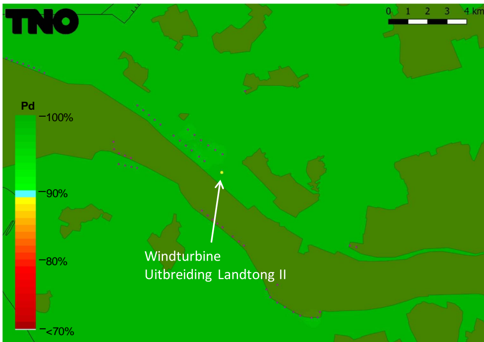
Figuur 8 Detectiekans van het primaire verkeersleidingsradarnetwerk op 1000 voet boven het bouwplan nadat deze is gerealiseerd. De locatie van de nieuwe windturbine is aangegeven met gele stip.
