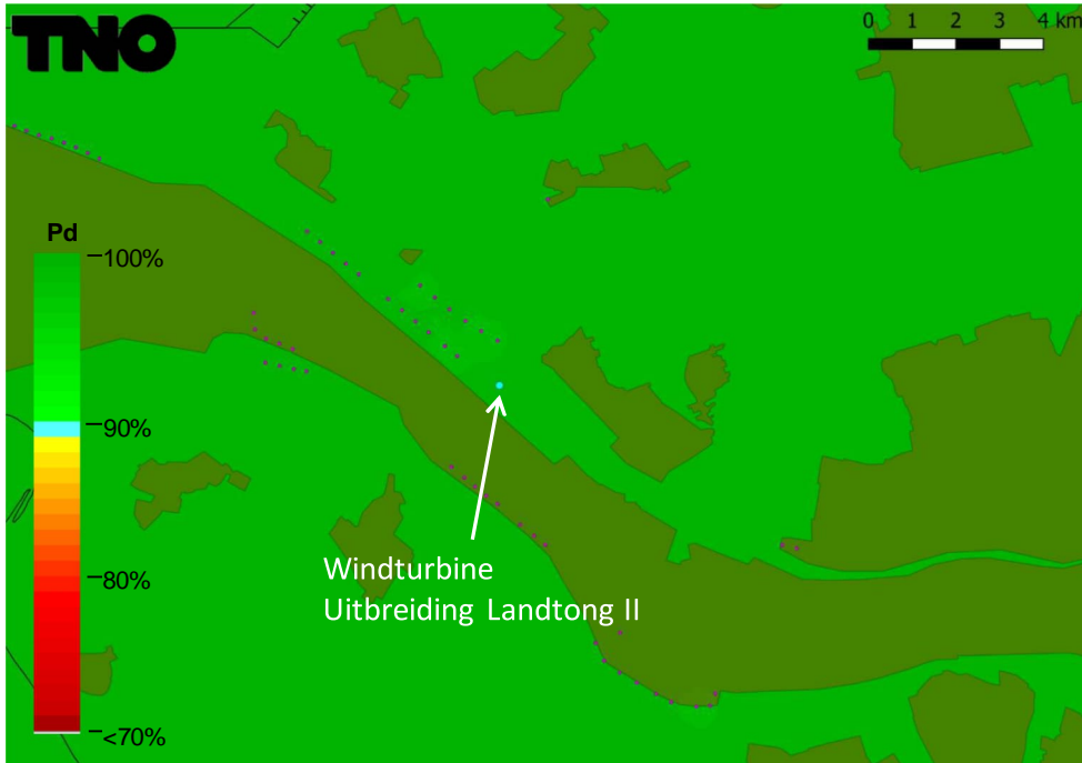
Figuur 13 Detectiekans van het primaire verkeersleidingsradarnetwerk op 1000 voet boven het bouwplan nadat deze is gerealiseerd. De locatie van de nieuwe windturbines is aangegeven met gele stippen.
