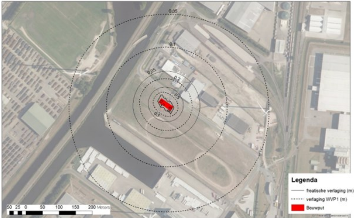
Figuur 24 Maximale verlaging grondwaterstand (einde bemalingsperiode) voor de bouwputbemaling
