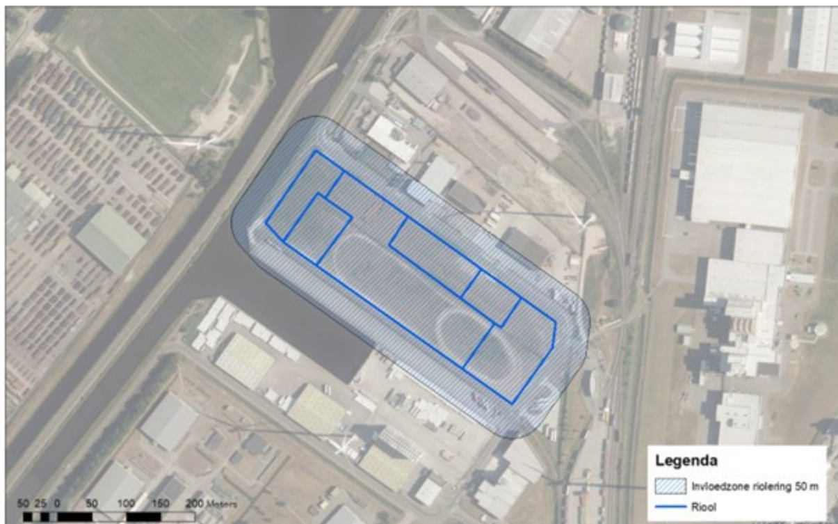
Figuur 27 Maximale invloedstraal (einde bemalingsperiode) voor de aanleg van de riolering en procesleidingen
