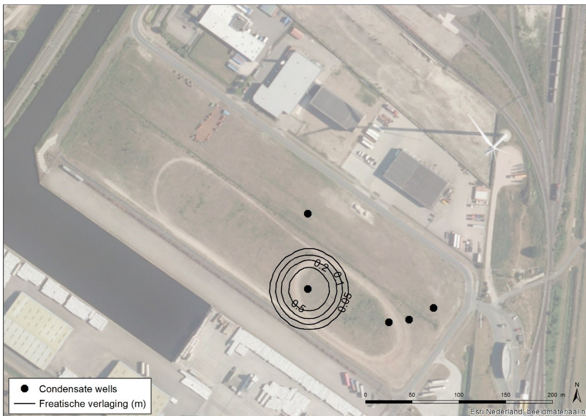
Figuur 25 Maximale freatische verlaging (einde bemalingsperiode) voor de bemaling per 'condensate well'
