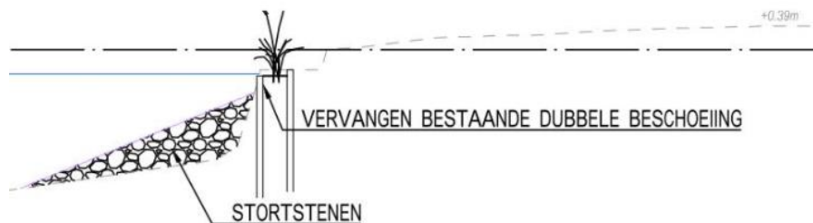
Figuur 24 Ontwerpprofiel stortsteen tegen bestaande beschoeiing
