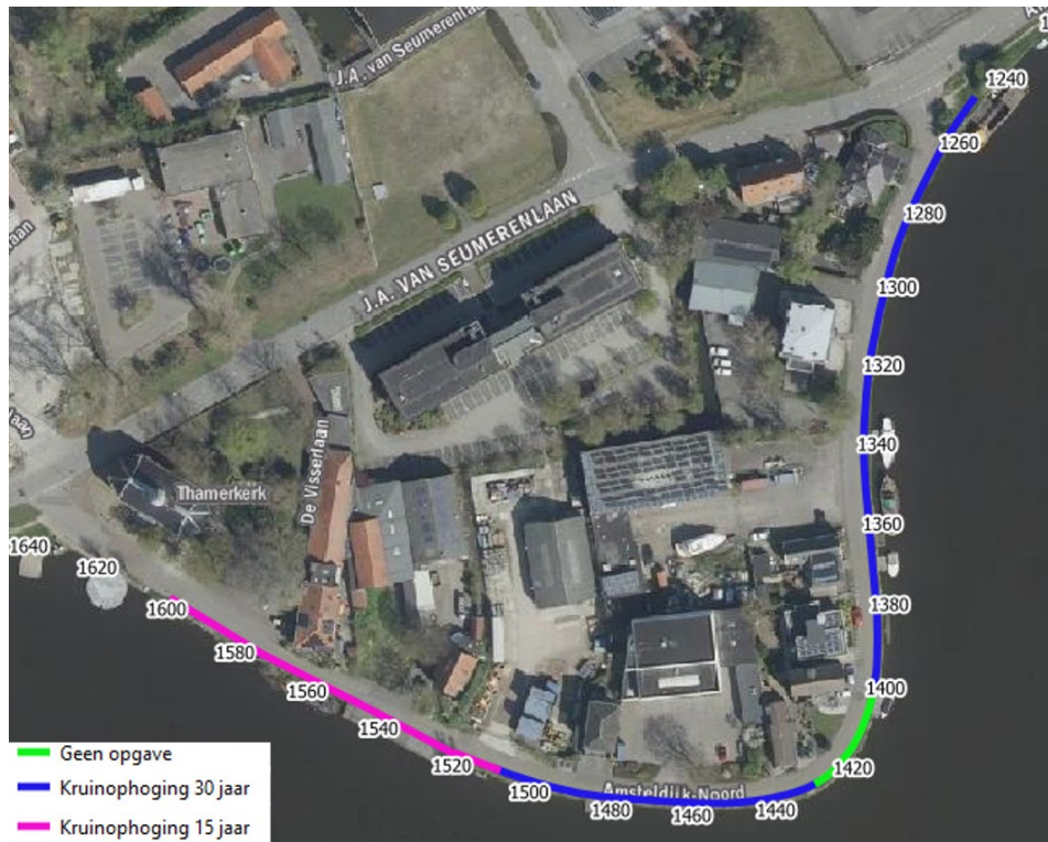
Figuur 28: Voorgestelde oplossing per deeltraject
