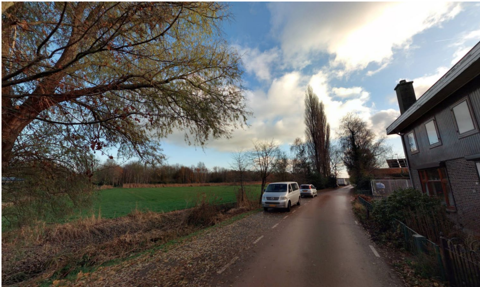
Cluster buitendijkse woningen ('t Zwanengat) ter hoogte van de voormalige voetveer. Teensloot met steil binnentalud, een groot deel van het binnentalud wordt gebruikt om te parkeren of is ingeplant. De kruin van de dijk is uitgevoerd in rood asfalt. De huizen en tuinen staan aan de bovenkant van het buitentalud, dicht op de kruin van de dijk. Achtertuinen grenzen aan het water en diverse boten liggen aan de beschoeiing.
