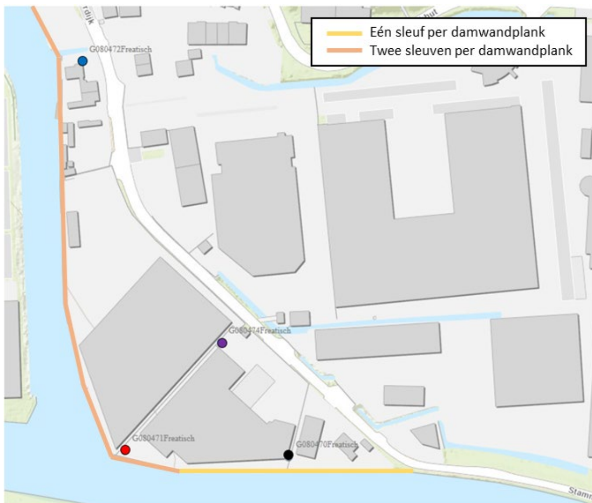
Figuur 13: Indicatieve locatie toepassing hoeveelheid sleuven per damwandplank volgens de specificaties uit Hoofdstuk 5.
