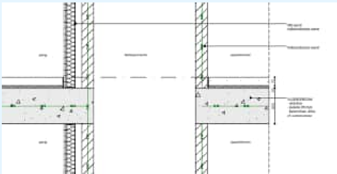
figuur 3: Detailtekening principe schachtwanden
