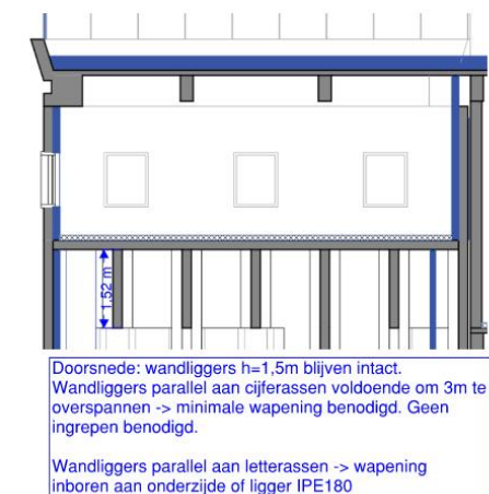
Figuur 3-17: opzet constructie ruwtaarwecellen
