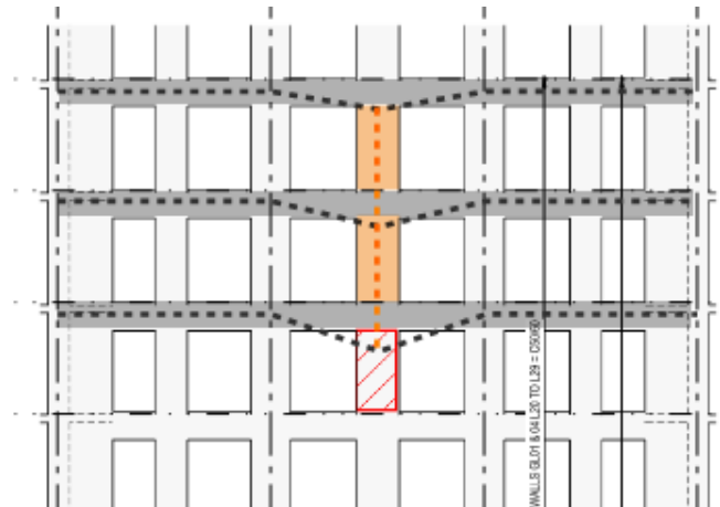
Figuur 0-7 Schema van het verwijderen van een kolom
