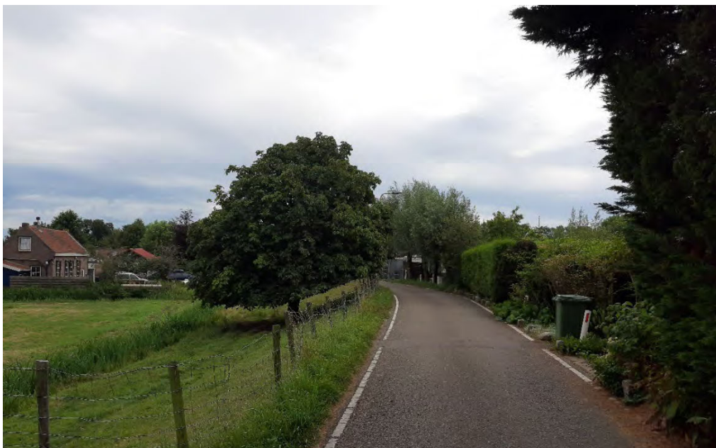
De Stammerdijk met steil binnentalud, erven op enige afstand van de dijk en doorgaande teensloot
