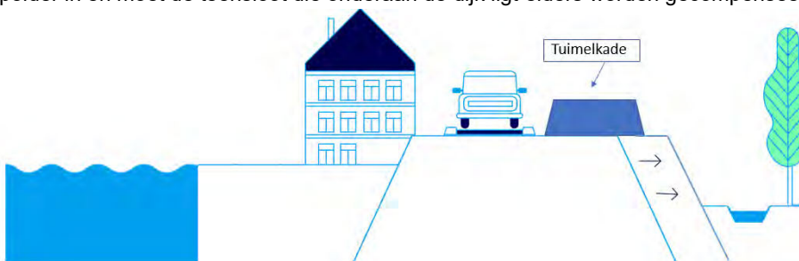
Figuur 37. Principeschets tuimelkade optie B
