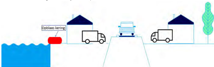
Figuur 11. Principeschets opblaasbare kering
