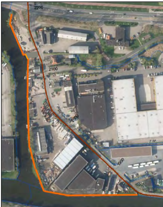
Plattegrond met schematisch weergegeven de damwand (oranje)
