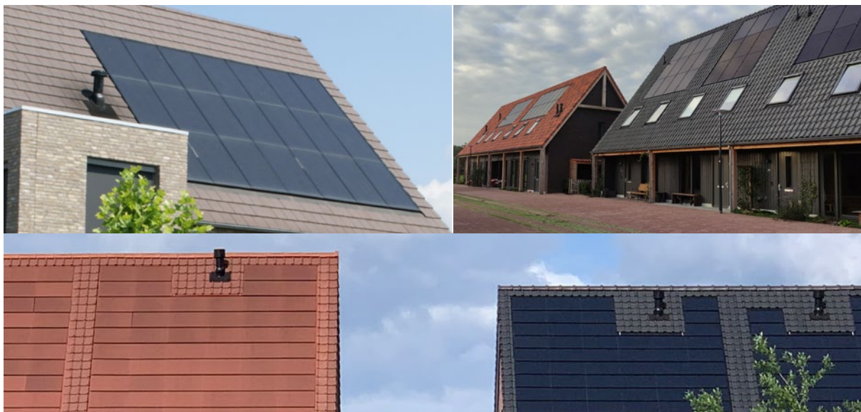
Afbeelding 53. Voorbeelden van zonnepanelen in het dakvlak.
