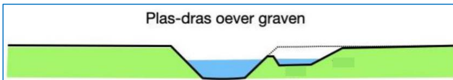
Figuur 10. Schetsmatige doorsnede watergang en natuurvriendelijke oever.
