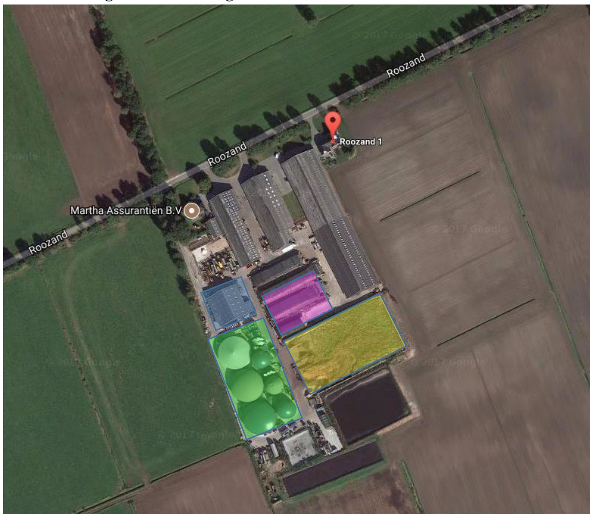
Figuur 2 Bovenaanzicht inrichting Hartlief-Lammers. Blauw = Drogerij, Groen = biovergisters, vloeibare opslag, WKK's en luchtwasser, Geel = opslag co-product, Paars = compostering
