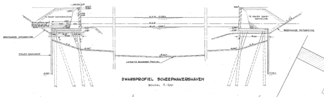
Figuur 3 dwarsprofiel kades en haven
