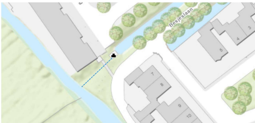
Afbeelding 3. Aan te brengen verbinding tussen gemaal en watergang
