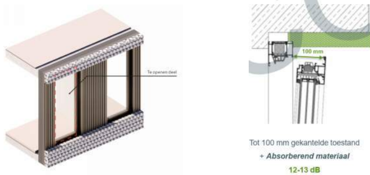
Figuur 3.3 Integratie geluiddempende voorziening boven raam.
