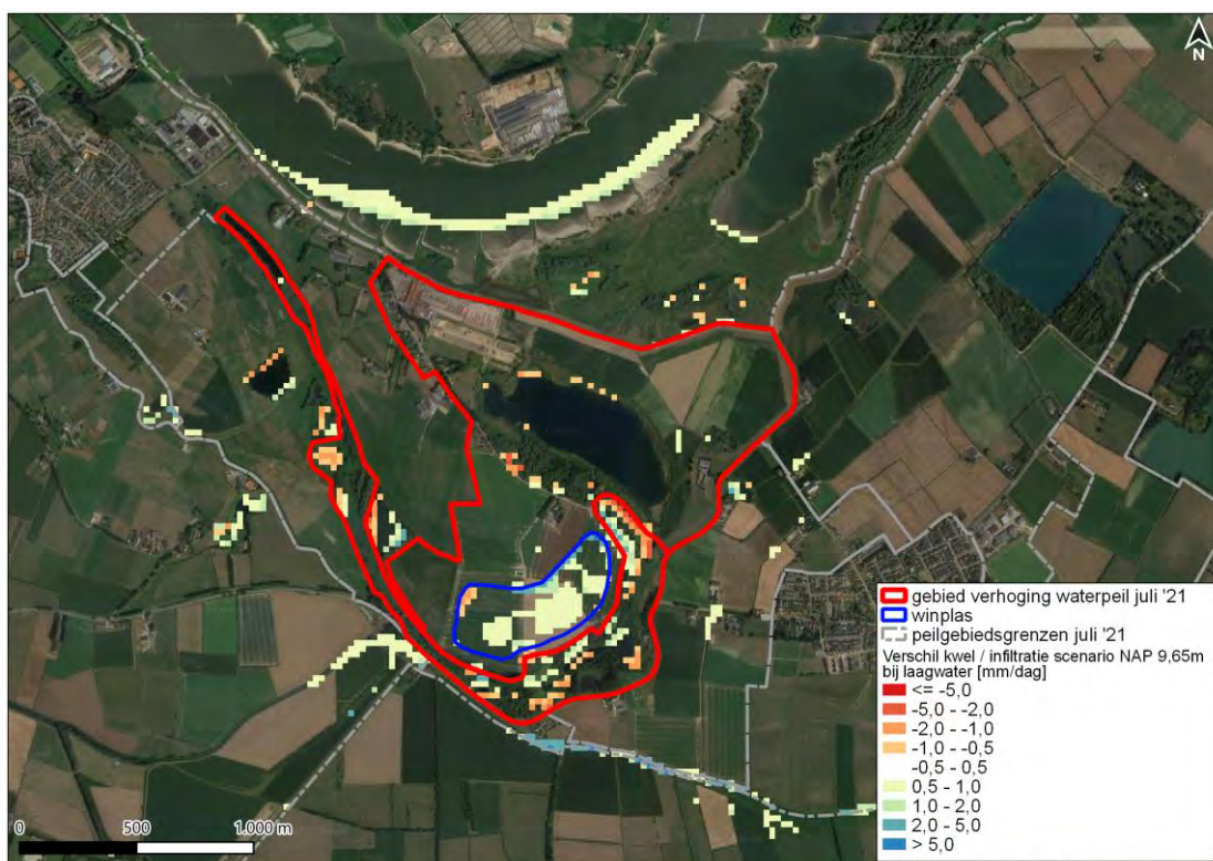
Afbeelding 8.25 Verandering in berekende kwelflux (rood=afname kwel of toename infiltratie, blauw=toename kwel of afname infiltratie) in het MORIA-model tijdens de laagwater situatie door scenario NAP +9,65 m
