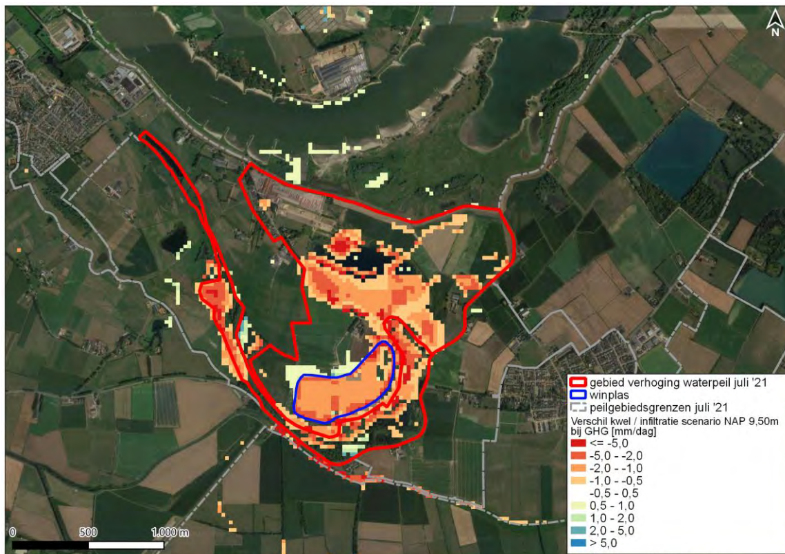
Afbeelding 7.27 Verandering in berekende kwelflux (rood=afname kwel of toename infiltratie, blauw=toename kwel of afname infiltratie) in het MORIA-model tijdens de GHG-situatie door het scenario NAP +9,50 m
