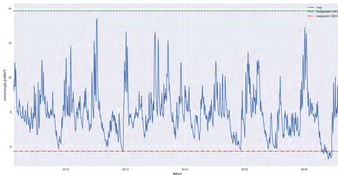
Afbeelding 4.9 Waterstanden Waal bij Ooij in m NAP in de periode die in het MORIA model zit en de hoog- en laagwaterstand van 2003 [gebaseerd op Waterinfo, RWS]
