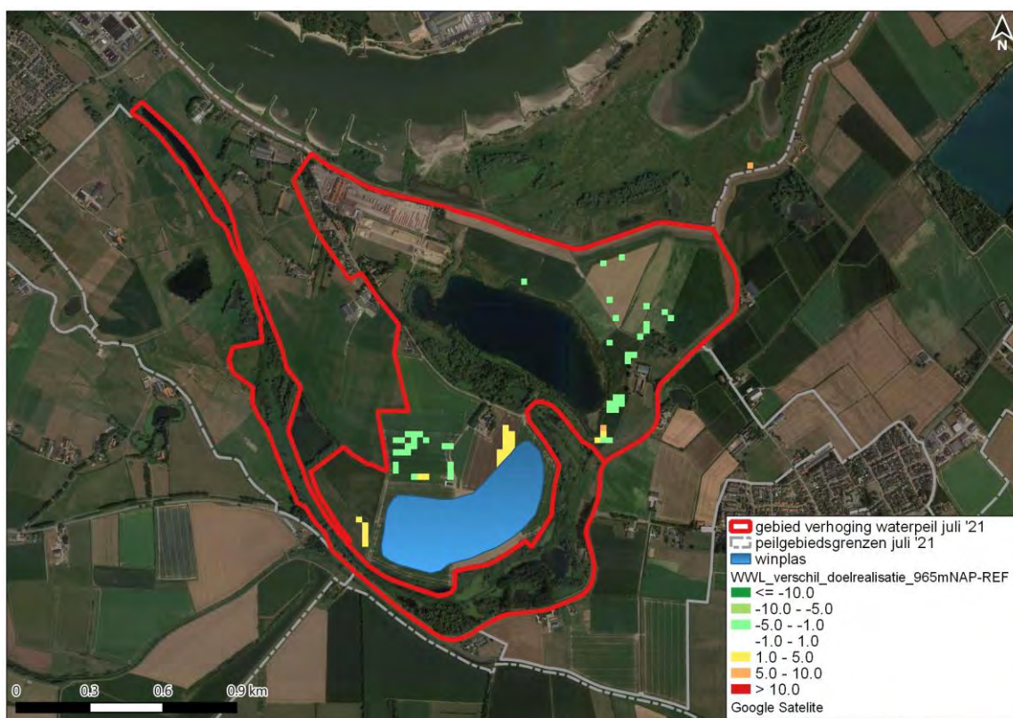
Afbeelding 8.31 Verandering in landbouwopbrengst derving in procentpunten door scenario NAP 9,65 m (rood (+) is afname van de doelrealisatie en groen (-) is een toename van de doelrealisatie)
