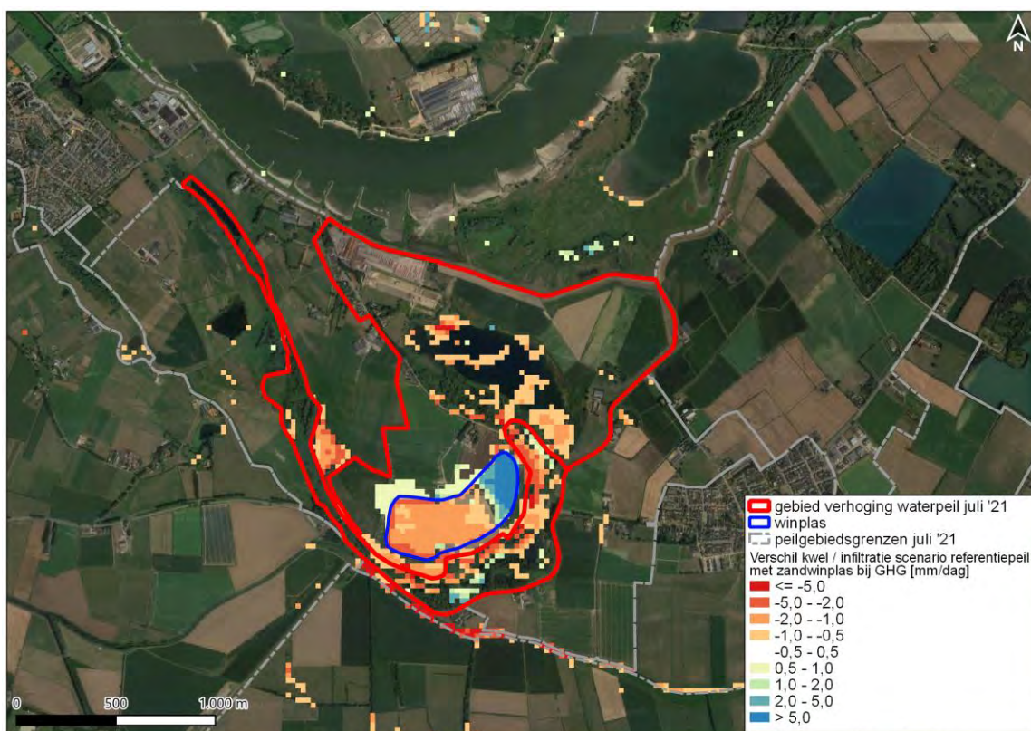
Afbeelding 5.27 Verandering in berekende kwelflux (rood=afname kwel of toename infiltratie, blauw=toename kwel of afname infiltratie) in het MORIA model tijdens de GHG situatie door het scenario referentiepeil met winplas
