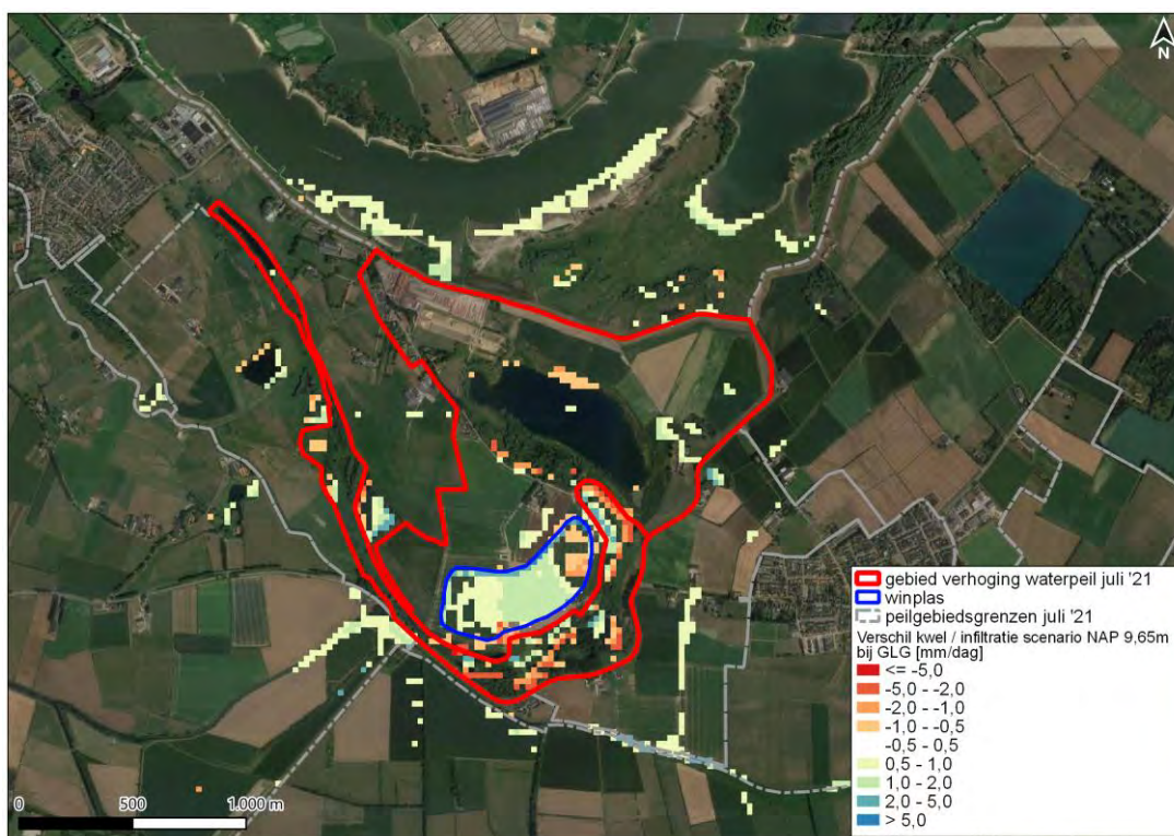
Afbeelding 8.29 Verandering in berekende kwelflux (rood=afname kwel of toename infiltratie, blauw=toename kwel of afname infiltratie) in het MORIA-model tijdens de GLG-situatie door het scenario NAP +9,65 m
