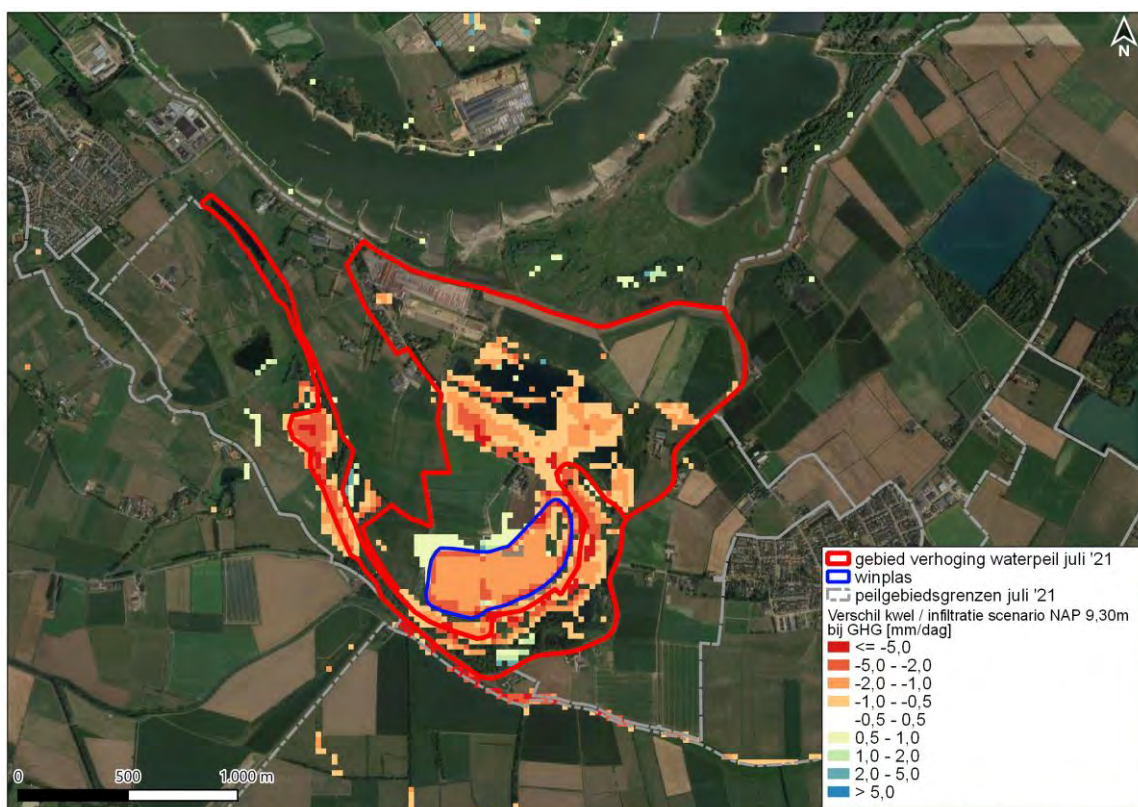
Afbeelding 6.27 Verandering in berekende kwel/flux (rood=afname kwel of toename infiltratie, blauw=toename kwel of afname infiltratie) in het MORIA model tijdens de GHG situatie door het scenario
