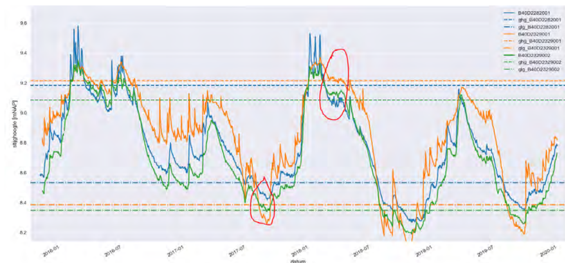
Afbeelding 4.10 Grondwaterstanden en GHG (gemiddeld hoogste grondwaterstand) en GLG (gemiddeld laagste grondwaterstand) van de peilbuizen in en rondom het plangebied
