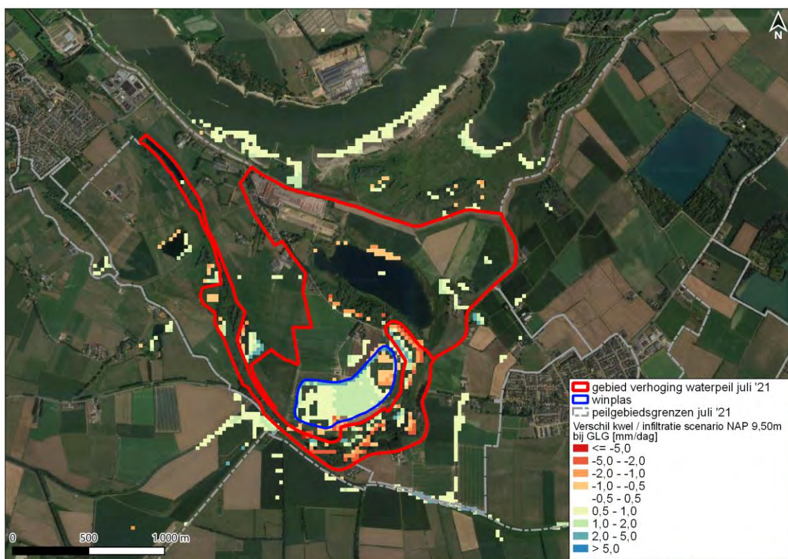
Afbeelding 7.29 Verandering in berekende kwelflux (rood=afname kwel of toename infiltratie, blauw=toename kwel of afname infiltratie) in het MORIA-model tijdens de GLG-situatie door het scenario NAP +9,50 m
