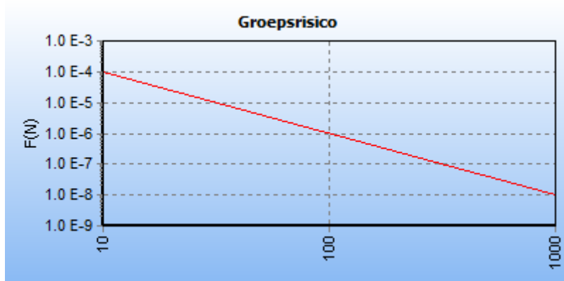
5.4 Figuur 5.4 FN curve voor 7529_leiding-N-578-13-deel-1 van N.V. Nederlandse Gasunie voor de kilometer tussen stationing 0.00 en stationing 30.00
