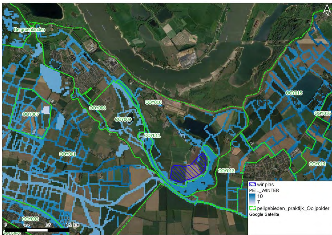
Afbeelding 4.11 RIV-cellen in het MORIA-grondwatermodel
