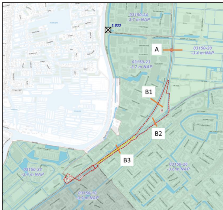
Figuur 1: Peilgebieden met doorsneden. Bestaande, door ProRail in 2015 aangebrachte, beschoeiing weergegeven in geel. Binnen gebied A is een peilverhoging van 30 cm voorzien. In gebied B gaat het om 10 cm.
