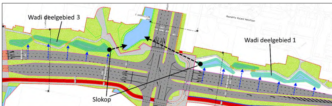
Figuur 4-3 Wadi's zoals opgenomen in het ontwerp.
