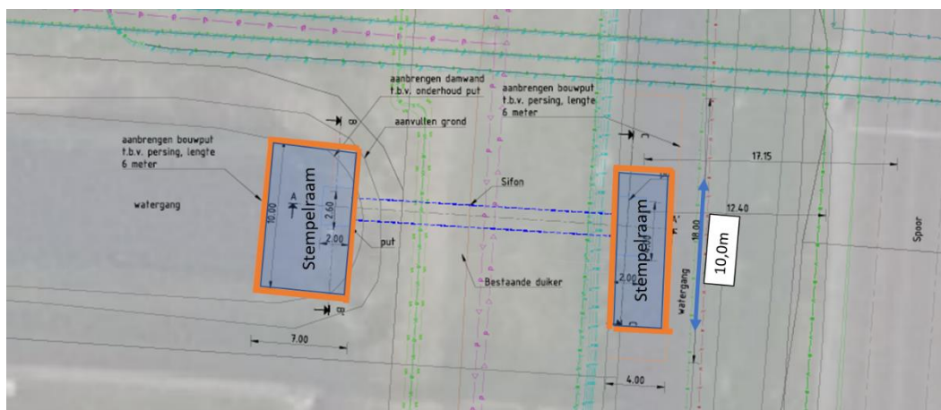
Figuur 3-4: Aangepast ontwerp tijdelijke damwand locatie IV
