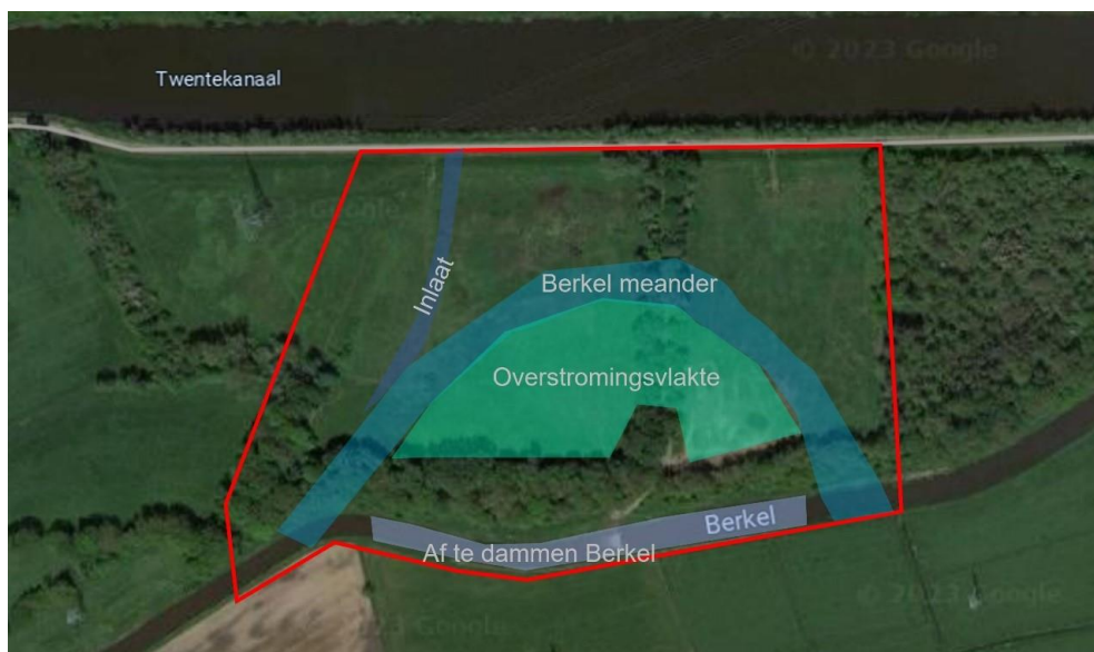
Figuur 3.2: rode omlijnning betreft de globale begrenzing van het deelgebied depot Dochteren. Daarnaast is de globale ligging van de hoofdonderdelen weergegeven
