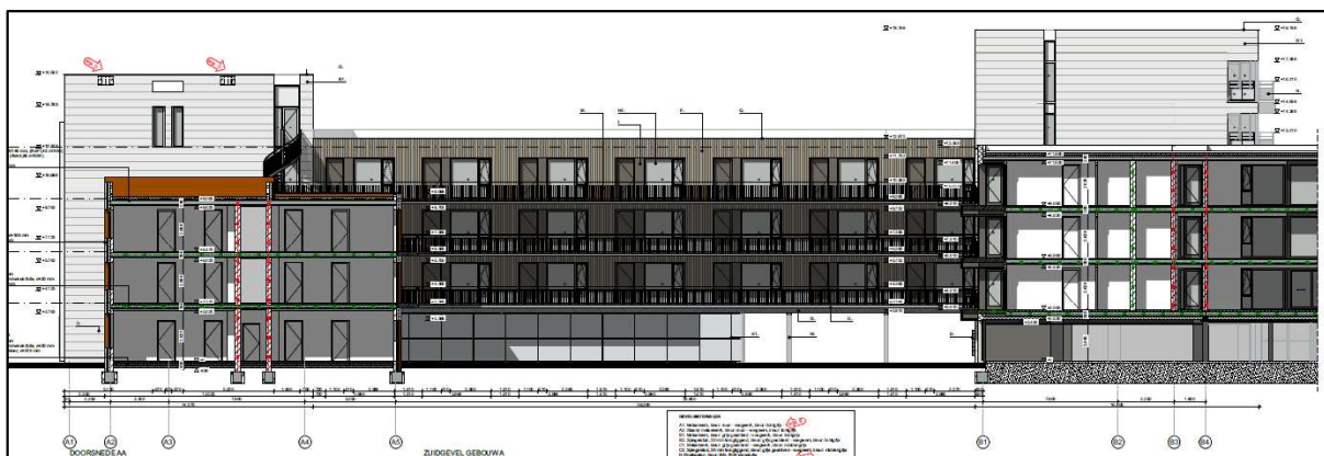
Figuur 4. Locatie van de permanente voorzieningen in de zuidgevel van de nieuwbouw weergegeven met een rode pijl (Op de tekening zijn 4 geschakelde kasten van het type IB VL 07 in combinatie met IB VL 08 te zien. Echter worden in de nieuwe situatie 6 kasten geschakeld, 2 boven en 3 naast elkaar).
