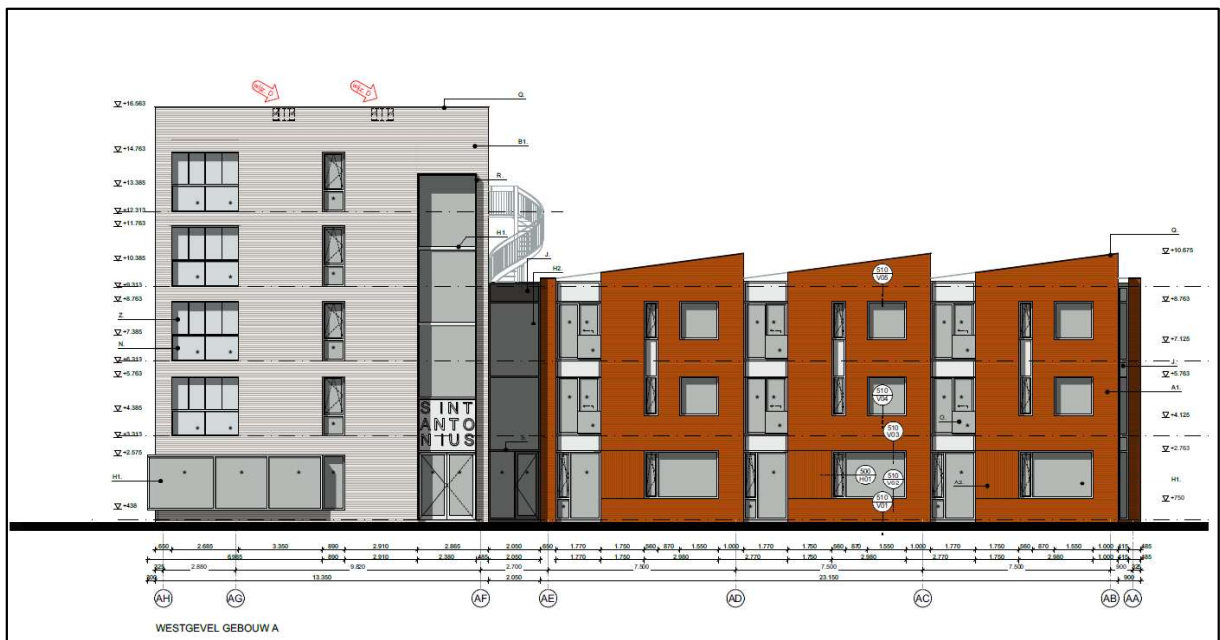
Figuur 3. Locatie van de permanente voorzieningen in de westgevel van de nieuwbouw weergegeven met een rode pijl (Op de tekening zijn 4 geschakelde kasten van het type IB VL 07 in combinatie met IB VL 08 te zien. Echter worden in de nieuwe situatie 6 kasten geschakeld, 2 boven en 3 naast elkaar).
