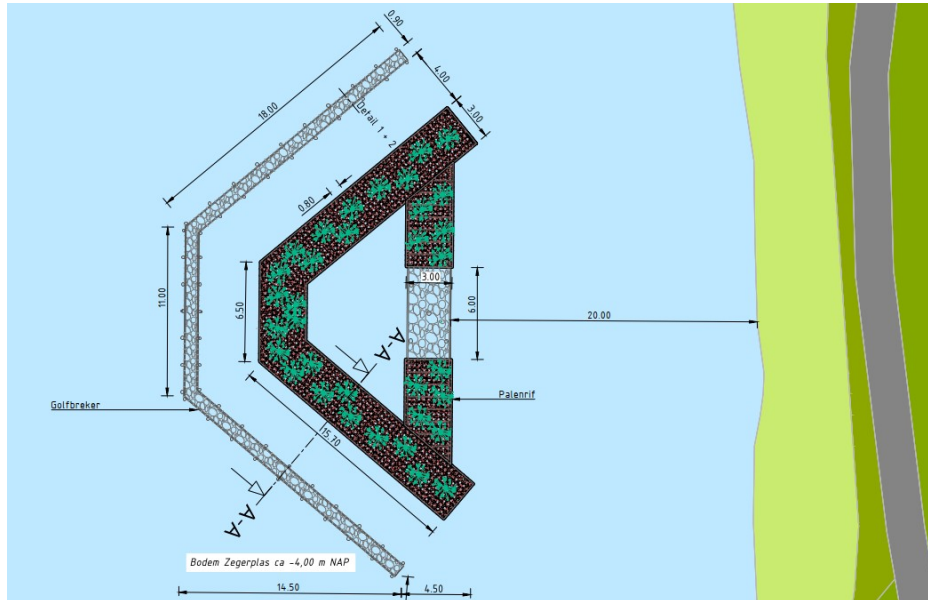
Afbeelding 2.6 Palenrif & golfbreker (detail bovenaanzicht)
