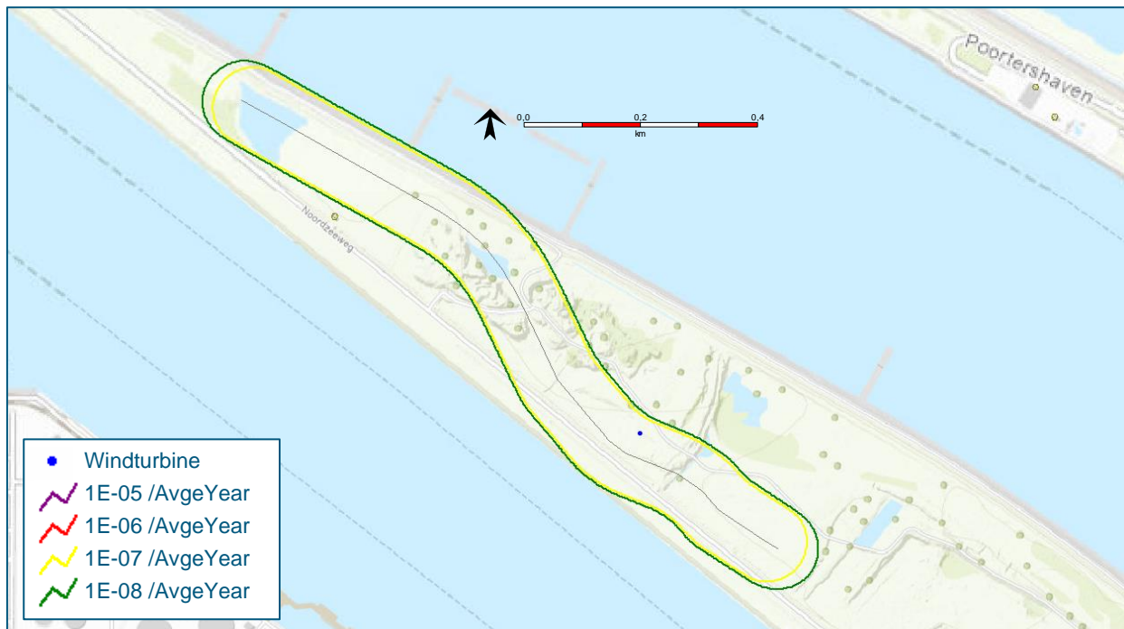
Figuur 5 Plaatsgebonden risicocontouren huidige situatie Shell transportleiding (alleen het risico van de leiding rond de windturbine is in kaart gebracht)
