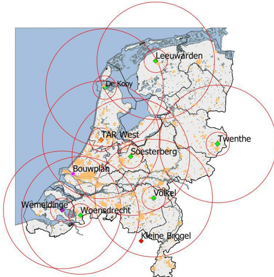
Figuur 3 Locaties van de zes MASS verkeersleidingsradarsystemen (groene ruit) met daaromheen de 15 en 75 km cirkels. De TAR West radar bij Schiphol is aangegeven met een oranje ruit en de infill radar te Wemeldinge met een paarse ruit. De oranje vlakken zijn de in de AHN-1 gedefinieerde stedelijke gebieden. De ligging van het te toetsen bouwplan is aangegeven met een roze ster.
