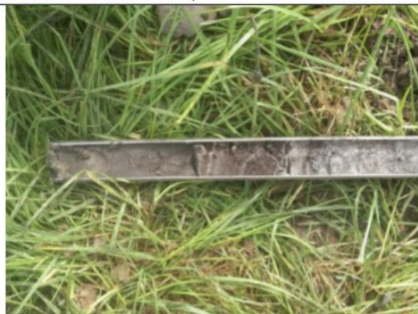
Boring 4 (overgang Almere Laag naar Flevomeer Laag; ca. 215 – 260 cm -mv)
