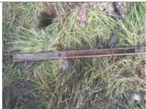
Boring 2 (overgang Basisveen Laag naar dekzand; ca. 550 – 630 cm -mv)
