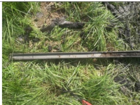
Boring 5 (overgang Hollandveen naar Wormer Laagpakket; ca. 420 – 490 cm -mv)
