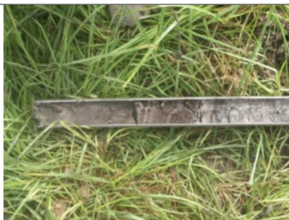
Boring 4 (overgang Almere Laag naar Flevomeer Laag; ca. 215 – 260 cm -mv)
