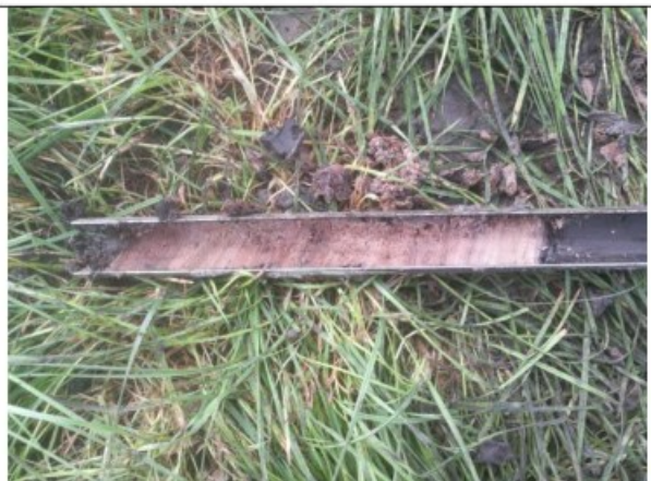
Boring 3 (houtfragment op Wormer geulafzetting; ca. 515 – 555 cm -mv)
