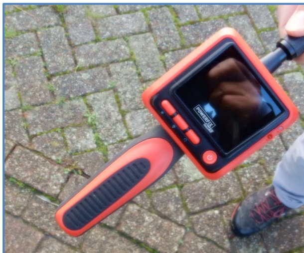
De bij de inspectie van de holten gebruikte endoscoop. Links het handvat. Op het scherm is het beeld te zien van een camera met lampje die met een slangetje in de holte wordt gebracht.
