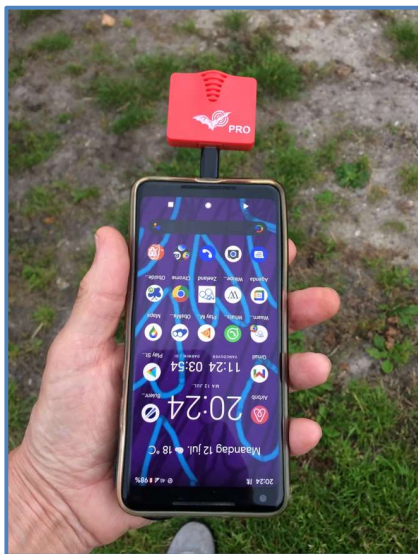
De gebruikte Echo Meter Touch 2 Pro bat-detector.
