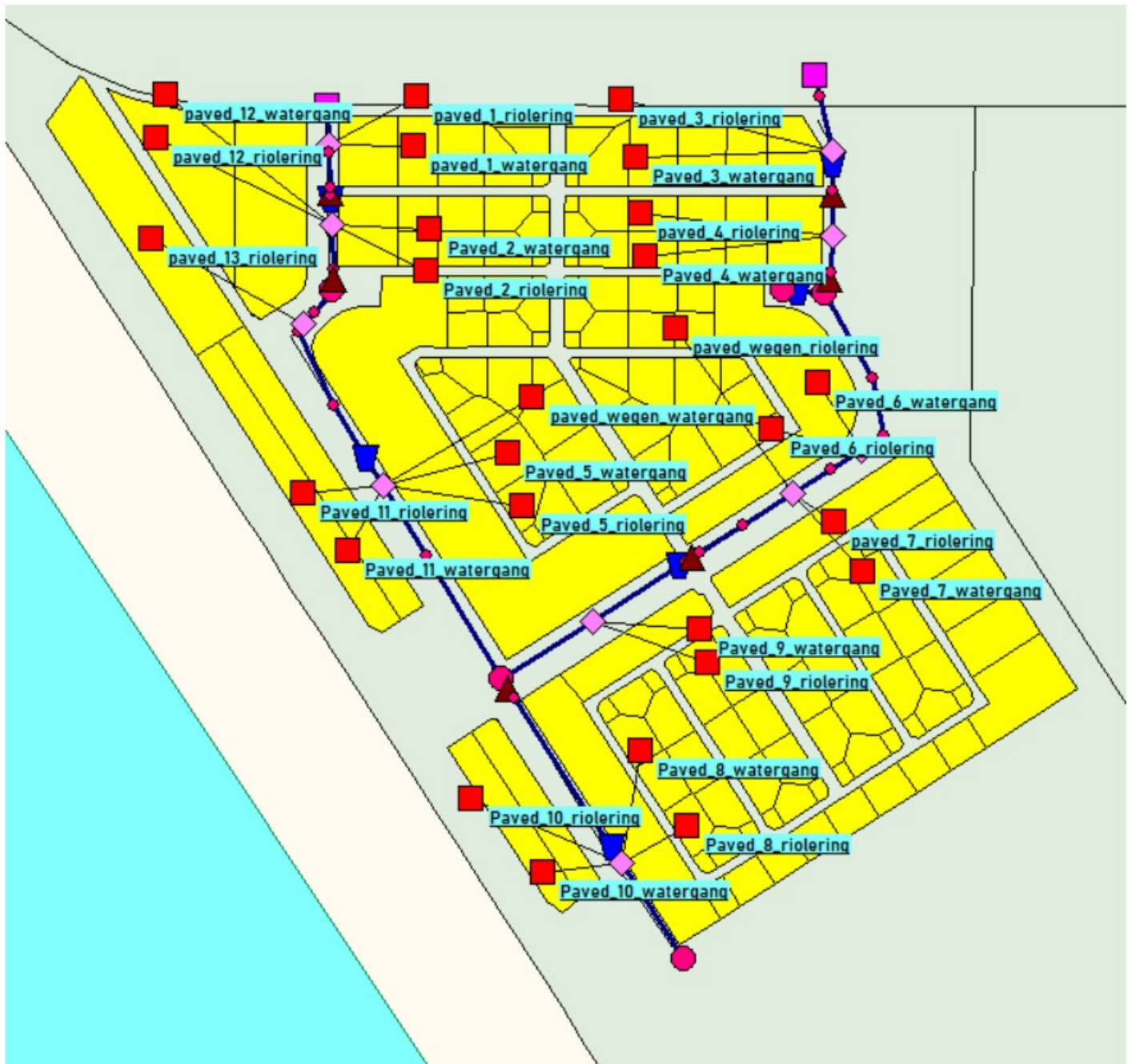
Figuur 4-3 Schematisatie van het ontwerp in het SOBEK-model. De rode vierkanten geven de verschillende verharde oppervlakte weer.
