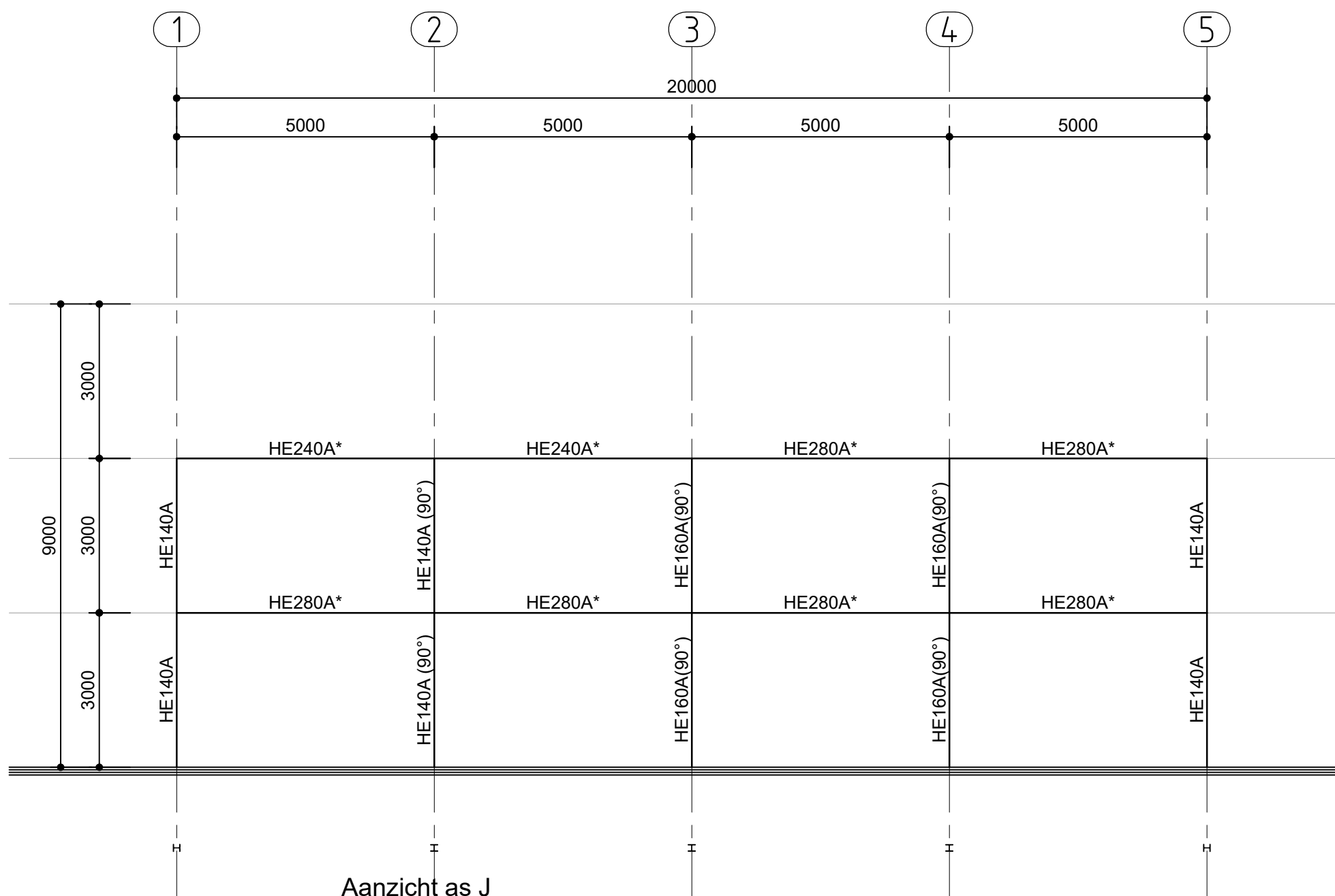
Aanzicht as J HE280A* = ontflenste ligger conform detail 1 HE240A* = ontflenste ligger conform detail 1
