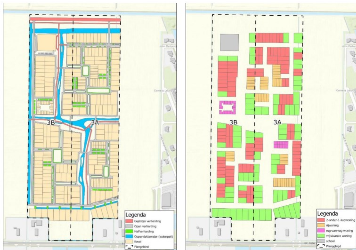
Afbeelding 7: Verhard oppervlak wegen en kavels per fase, en verdeling type kavels
