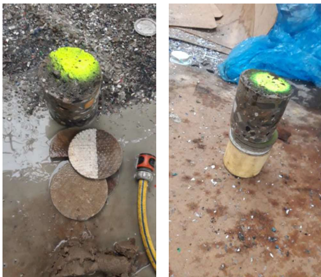
Figuur 3.1 Asbestverdachte isolatielaag
