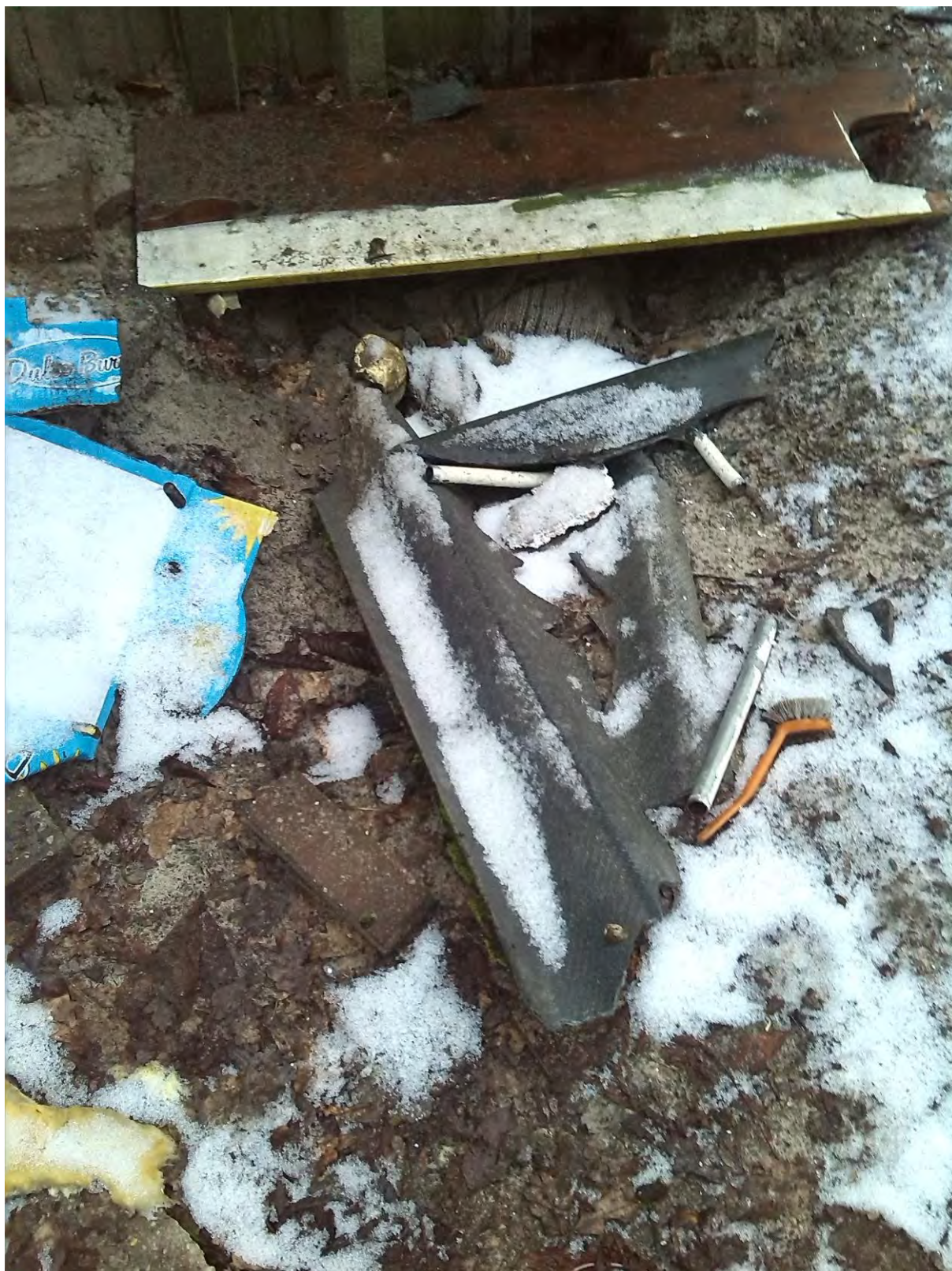
Foto 4: restanten asbestverdacht golfplaat bij werkplaats 3
