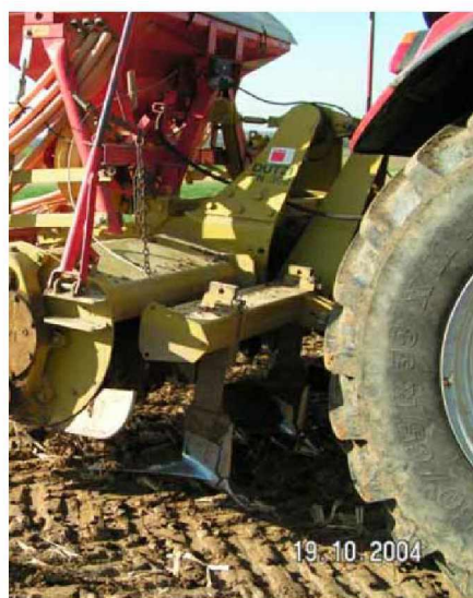
fig. 2 Pennenfrees met 4 brede beitels
