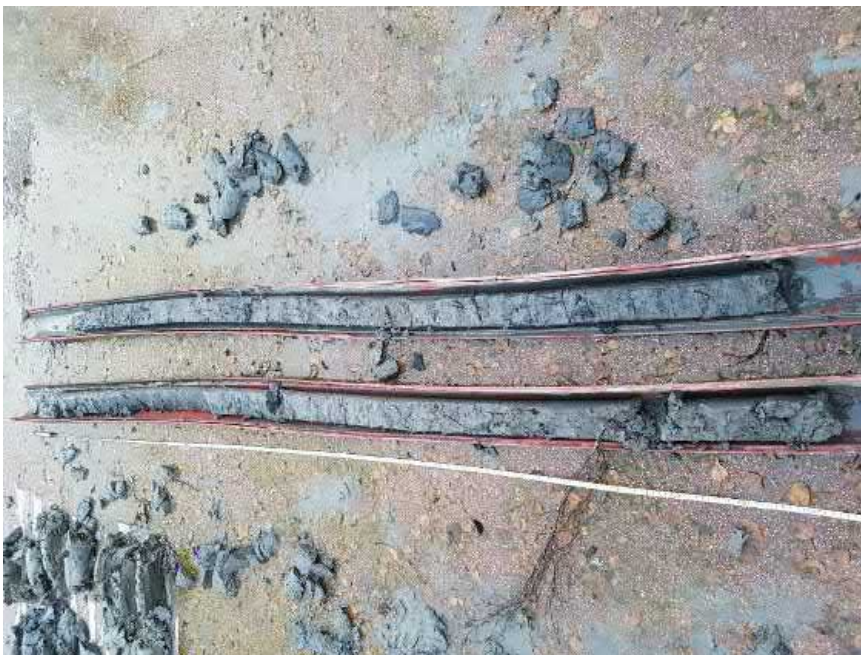
Afbeelding 5. De boorkernen van de mechanische aqualock. Foto Sweco 2020-01-07.
