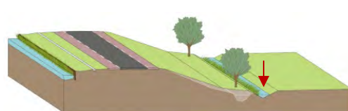
Figuur 3.8 Teenslootvergraving (STBI 1)
