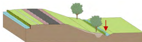
Figuur 3.6 Teenslootvergraving (STBI 1)
