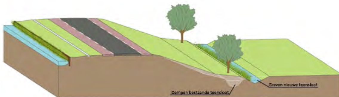
Figuur 25 - Bouwsteen STBI1 teenslootvergraving
