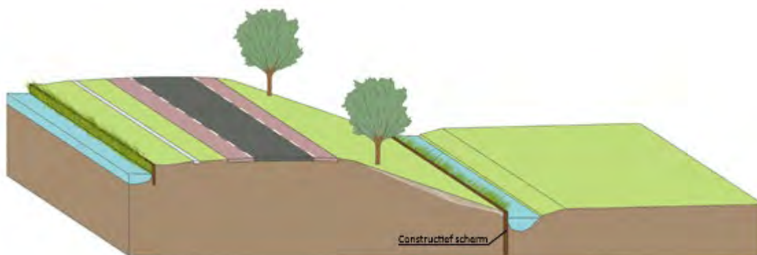
Figuur 26 – Bouwsteen STBI3 Constructief scherm in teensloot
