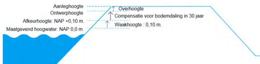
Figuur 2: De hoogte waarop een dijk moet worden opgehoogd
