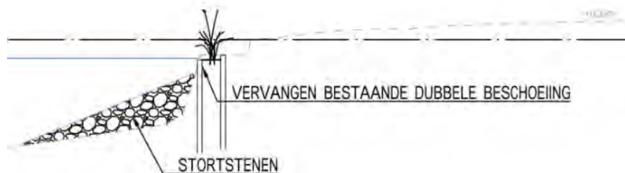
Figuur 24 Ontwerpprofiel stortsteen tegen bestaande beschoeiing
