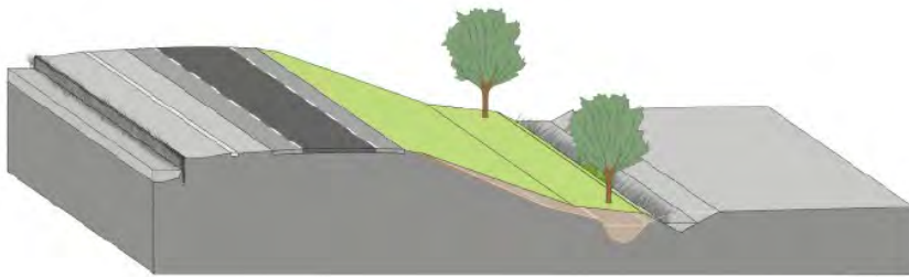
Figuur 12: Voorkeursvariant 2A, aanbrengen steunberm, vergraven teensloot en herplanten knotwilgen
