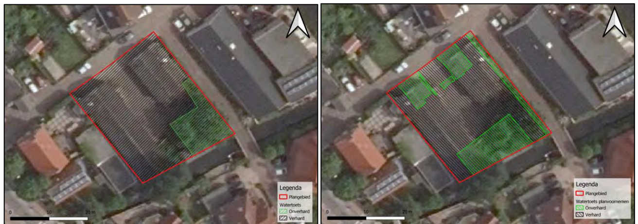
Figuur 5: Verhard en onverhard terrein in de huidige (links) en toekomstige situatie (rechts).
