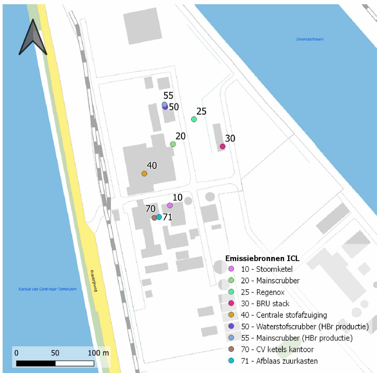
Figuur 6. Overzicht met de locaties van gekanaliseerde emissiebronnen op het terrein van ICL-IP.
