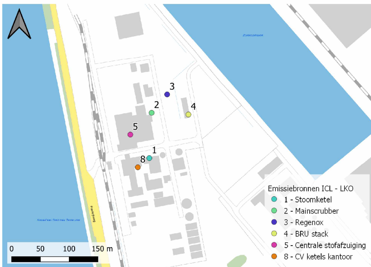
Figuur 1: Locaties van voor luchtkwaliteit relevante gekanaliseerde emissiebronnen bij ICL-IP (coördinaten staan in bijlage 1).
