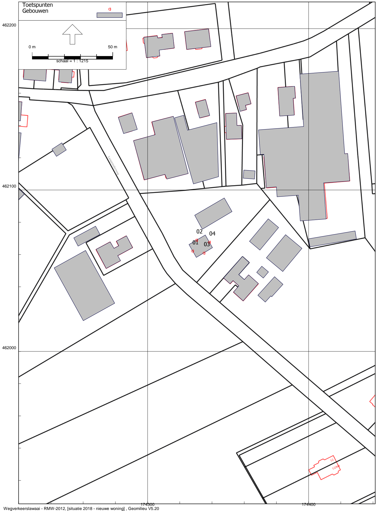
figuur 2: Overzicht rekenmodel met positie rekenpunten
