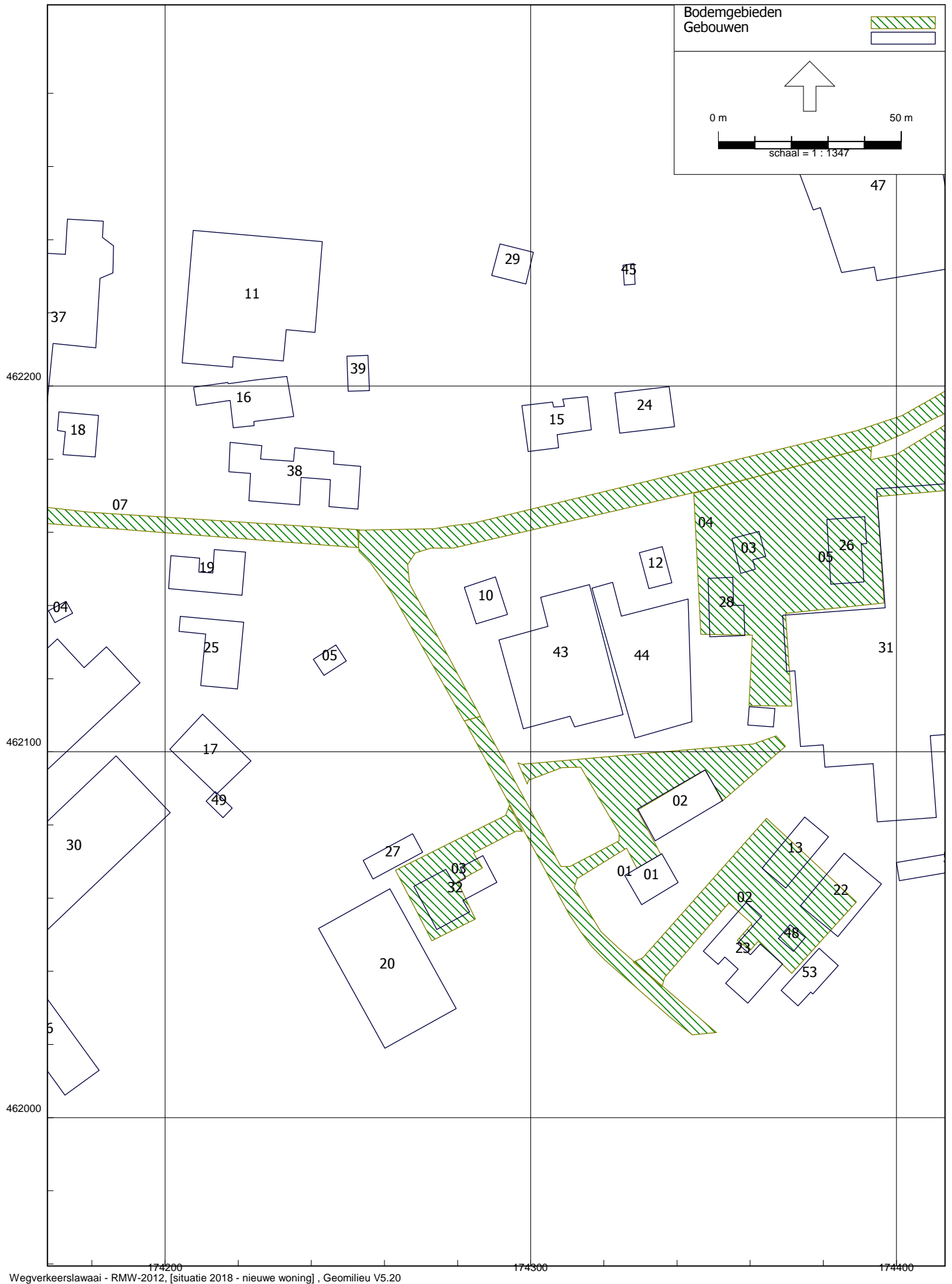
figuur 3: Overzicht rekenmodel met positie objecten en bodemvlakken
