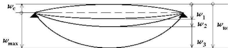
Figuur 1: Schematisch overzicht van de doorbuigingen van een constructief element (bron: NEN-EN 1990).
