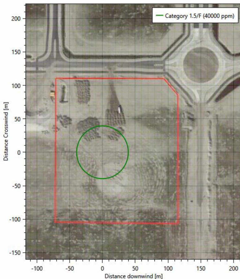
Figuur 3.3.5 40000 ppm waterstof wolkbrand contour van lage druk waterstofleiding in leidingbrug
