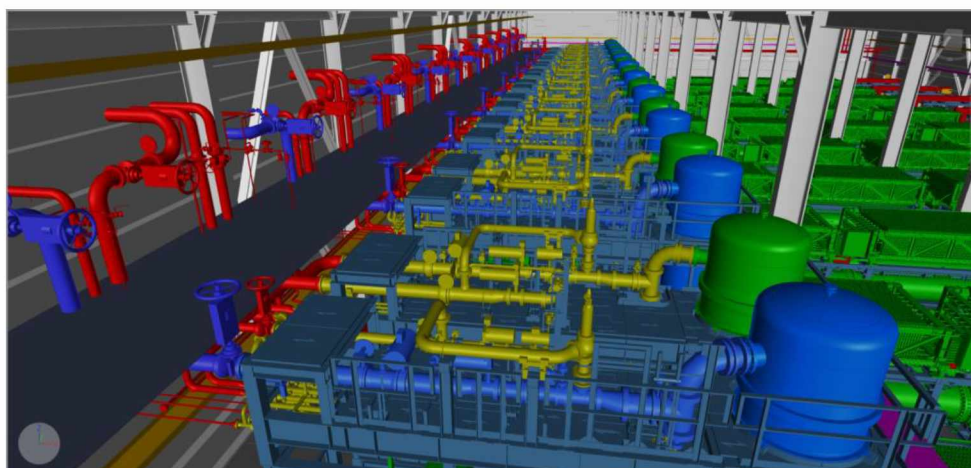
Afbeelding 3.3.1 10 elektrolyse-units binnen elektrolysegebouw
