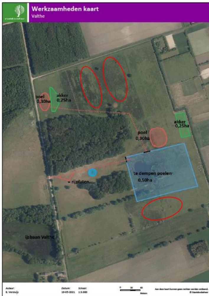
Figuur 2. Locatie van de te dempen besmette poelen (blauw) en indicatieve locatie van het nieuw te realiseren voortplantings- (rood) en landhabitat (groen)
