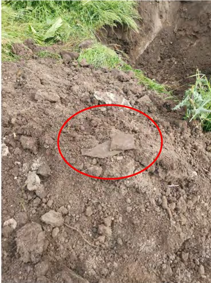
Asbesthoudend materiaal in depot
