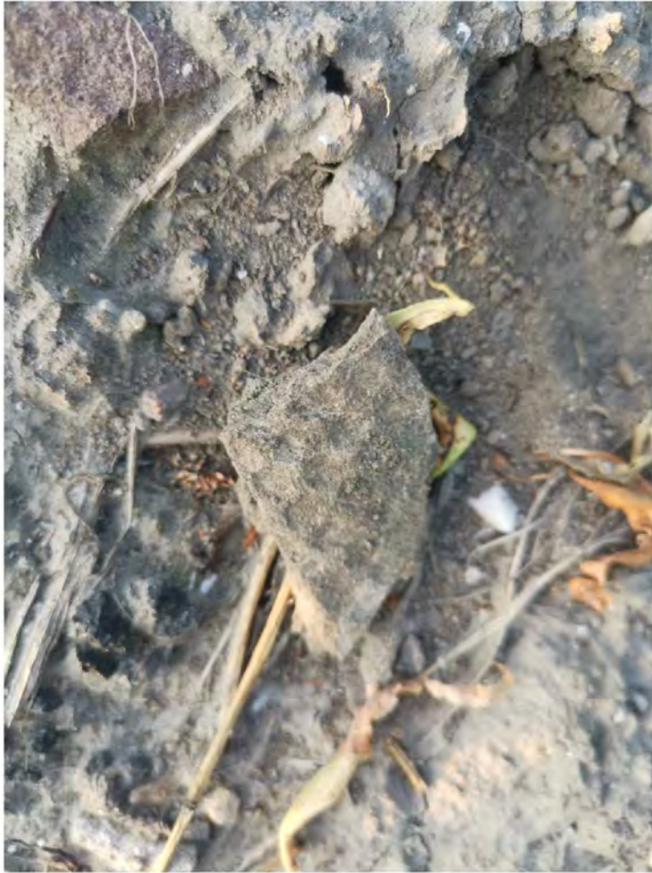
Asbesthoudend materiaal in depot
