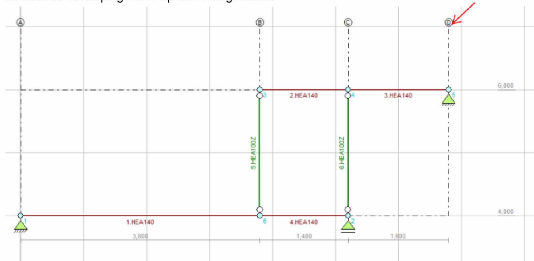
Figuur 19: doorsnede A constructieschema
