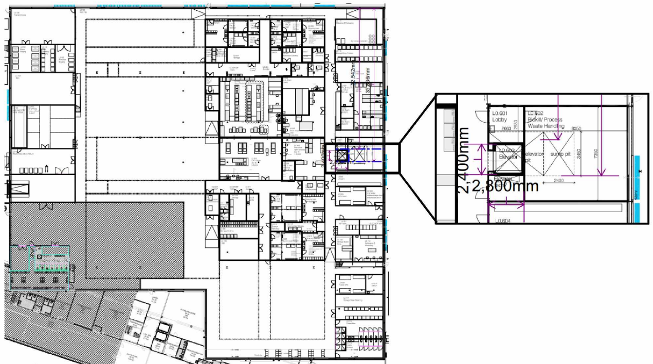
Figuur 17: raveelconstructie t.b.v. lift
