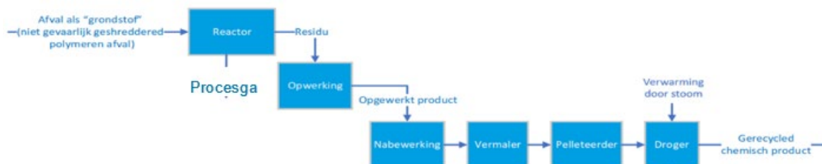
Figuur 2.1 Processchema van de stappen die rubberen snippers doorlopen tot product
