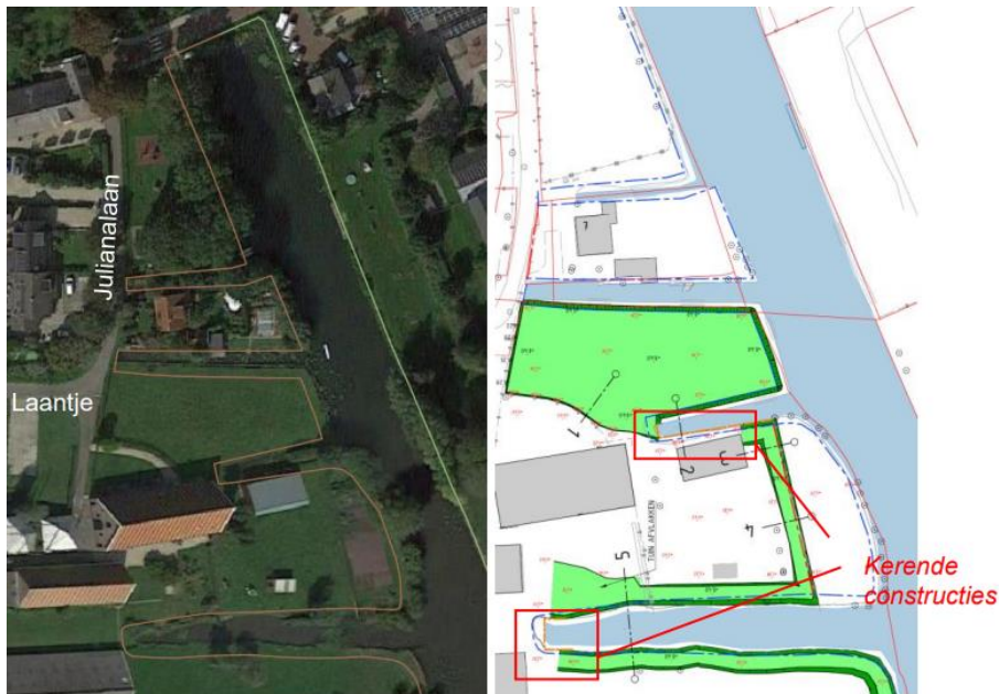
Figuur 4-3. Dijkvak 5 huidige situatie (links) en ontwerp (rechts)
