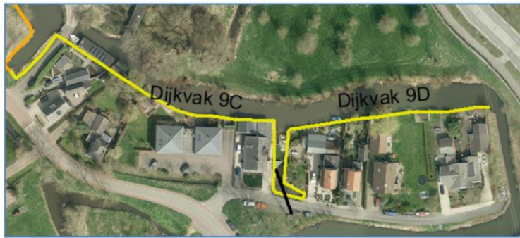
Afbeelding 4.7 Dijkvak 9c en 9d. Op de gele lijn ligt nu de referentielijn van de dijk
