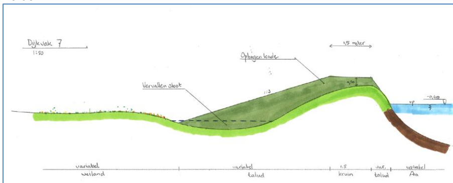
Figuur 37 Dijkverbeteringsalternatief ‘Ophogen en versterken binnentalud (inclusief dempen sloot m2200-2400)’
