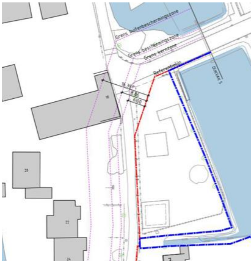
Figuur 4-2. Leggerwijziging ter hoogte van de speeltuin. Blauw is de huidige referentielijn, rood is de nieuwe referentielijn.
