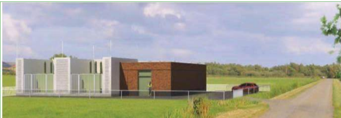
Figuur 2. Algemene impressie van een standaard transformatorstation.
